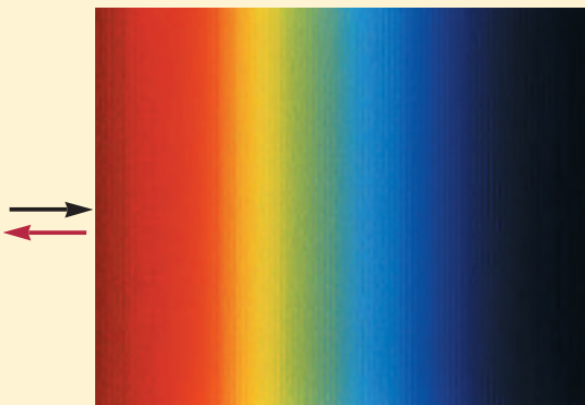
入射光中心頻率為1550奈米，產生全反射。顏色代表相對光場強度。紅色最強，藍色最弱。紅色為光波共振最強烈之處。
