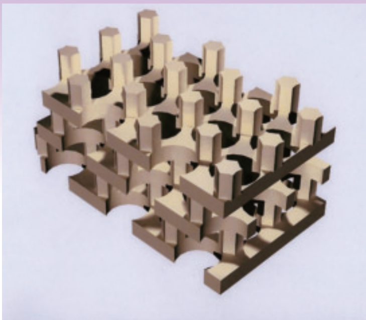
三維光子晶體結構 二〇〇〇年由強生 (Steven Johnson) 和貞諾普羅 (John Joannopoulos) 提出。
