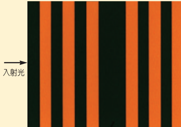
「缺陷」薄膜，厚度 ( 1/2\lambda ) 比其他層 ( 1/4\lambda ) 大，破壞了周期性結構。
